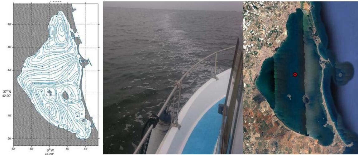
Figura 2. Esquema hidrodinámico de corrientes y localización de un frente de espumas encontrado en 2017.
